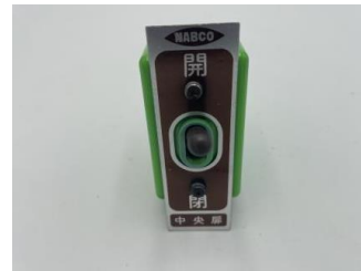
（バス廃品（放出品）） 産交バス車両で実際に使用 し、現役を退いた路線バス車両 の「ドア開閉スイッチ」
